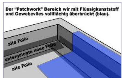
Befindet sich die Fläche anschließend in einem spannungsfreien Zustand wird die für den Untergrund geeignete PU-Grundierung gleichmäßig dünn aufgetragen. Ist die Grundierung getrocknet wird die "gewebebearmierte PU-Dichtschicht" aufgebracht.
