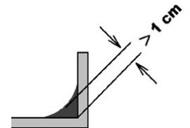
Nach 24 Stunden ist die PU-Dichtmasse zwar noch im Untergrund weich kann aber durchaus mit weiterem Material überarbeitet werden. Man kann sie auch **“nass in nass“** mit unseren PU-Flüssigkunststoffen überarbeiten, hierbei muss lediglich darauf geachtet werden, dass die erstellte Form und Oberfläche dabei nicht beschädigt wird.
