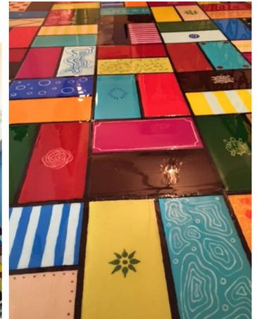
Eine alte Terrakotta-Tischplatte wurde in 2009 mit dem transparenten **"DIMESEAL®" 451 PU-Flüssigkunststoff** beschichtet. Anschließend stand dieser Tisch sieben Jahre lang ungenutzt im Außenbereich und wurde erst 2017 wieder gereinigt.
