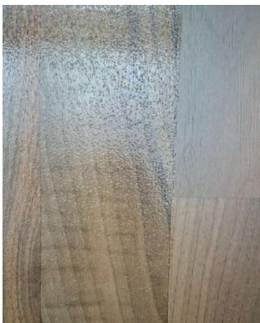
Links wurde ein handelsüblicher Laminatboden mit dem **"DIMESEAL®" 451 PU-Flüssigkunststoff** sowie einer Quarzsand-Einstreuung rutschsicher gemacht.
