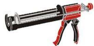
Die PU-Dichtmasse sollte abschnittsweise (ca. 1,0 bis 2,0 Laufmeter) aufgebracht und sofort geglättet bzw. modelliert werden, denn es bildet sich bereits nach wenigen Minuten ein hauchdünner Trockenfilm an der Oberfläche. Die 300 ml Kartusche reicht bei einer ca. 1 cm dicken Materialwurst für ca. 5,0 - 6,0 Laufmeter.
