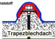
Je nach Länge der Verschraubungen ist es oftmals sinnvoll diese vorher zu kürzen damit man nicht so viel PU-Dichtmasse benötigt und dieser Bereich völlig überdeckt und dicht ist.
