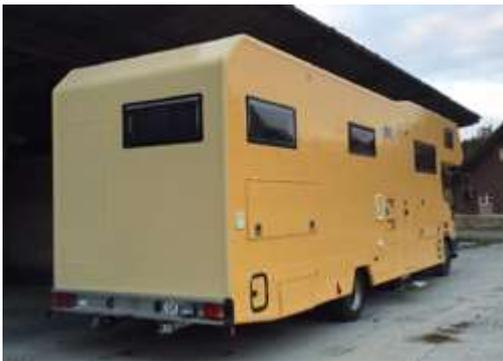
Bei dem hier gezeigten Wohnmobil wurden die Beschichtungsarbeiten vom Heimwerkerkunden in Eigenregie erstellt und das Ergebnis ist eine dauerelastische Abdichtung mit farbiger Endbeschichtung.
