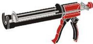
Die Verarbeitung erfolgt mittels handelsüblicher Kartuschen-Pistole. Man presst die bedarfsgerechte Materialmenge auf bzw. in den jeweiligen Bereich und modelliert die PU-Dichtmasse mit einem Spachtel oder Pinsel. Der Kartuschen Inhalt von 300 ml reicht bei einer ca. 1,0 cm dicken Materialwurst für eine Eckabdichtung (Hohlkehle) von ca. 6 - 7 Laufmeter.
