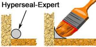
Das Einsatzgebiet umfasst alle Eck-, Naht- sowie Fugenabdichtungen. Sie wird u. a. auch bei allen Abdichtarbeiten im Bereich von Schwimmbecken, Brunnen, Zisternen und Tanks eingesetzt.
