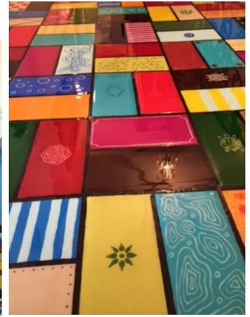
Eine alte und verblaste Terrakotta-Tischplatte wurde in 2009 mit vier Schichten transparentem **"DIMESEAL® 451"** PU-Flüssigkunststoff beschichtet. Anschließend stand dieser Tisch sieben Jahre lang ungenutzt und ungeschützt im Garten. Erst in 2017 wurde er zum ersten Mal gereinigt und seither benutzt.
