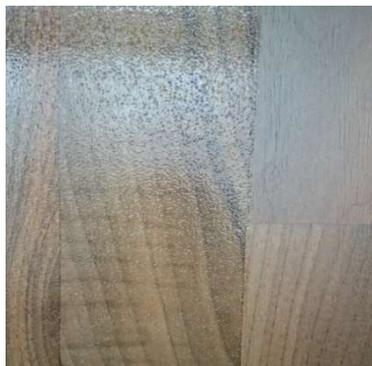
Links wurde ein handelsüblicher Laminatboden mit dem **"DIMESEAL® 451"** PU-Flüssigkunststoff sowie einer Quarzsand-Einstreuung rutschsicher gemacht.
