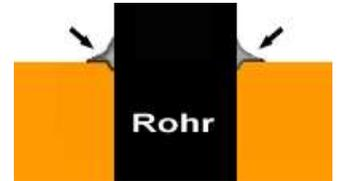
Die Verarbeitung erfolgt mit einer handelsüblichen Kartuschen-Pistole. Man presst die benötigte Materialmenge auf bzw. in den jeweiligen Bereich und modelliert die Oberfläche der PU-Dichtmasse **"HYPERSEAL-Expert"** mit einem Spachtel, Rakel oder einem mit **"SOLVENT"** Lösungsmittel getränkten Pinsel.
