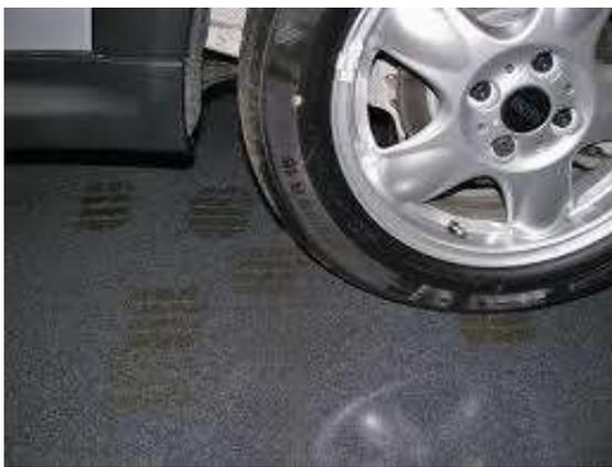
Die Beschichtung muss insbesondere **weichmacherresistent** sein, denn die in den Fahrzeugreifen befindlichen Weichmacher wandern ansonsten in die beschichtete Oberfläche und hinterlassen dort dunkle Stellen (siehe Foto links).
