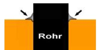
**“HYPERSEAL-Expert“** bildet um Auf- und Einbauten sowie um Rohre und Abflüsse herum eine dauerelastische Pufferzone. Damit dieser Bewegungszone ausreichend Platz zur Verfügung steht sollte die Dichtnaht mind. 10 mm breit und möglichst 1,0 mm tiefe besitzen.
