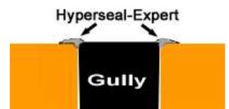
**“HYPERSEAL-Expert“** lässt sich auf Grund seiner Konsistenz, ähnlich wie ein Silikon, leicht verarbeiten. Mit einem in **“Solvent“** Lösungsmittel getränkten Pinsel kann die PU-Dichtmasse an der Oberfläche geglättet bzw. modelliert und verteilt werden. Der zu behandelnde Untergrund muss tragfähig gestaltet werden, d. h. Metall- oder Kunststoffteile sowie alte Farben müssen geschliffen und mit **“Solvent“** Lösungsmittel gereinigt werden.
