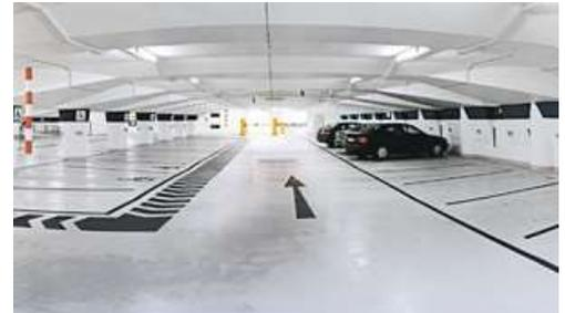
Billige Werkstoffe, z. B. einfache Betonfarbe, bringen auf einem Garagenboden zumeist ein billiges Endergebnis mit geringer Lebensdauer. Immerhin ist zu bedenken, dass ein Garagenboden erhebliche Belastungen aushalten muss.
