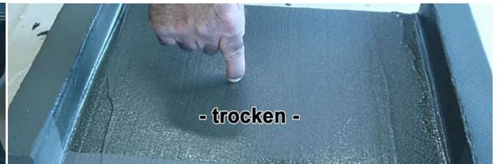
Im noch frischen Zustand erscheint die Oberfläche milchig (linkes Foto). Der Trockenprozess ist erst dann völlig abgeschlossen, wenn die Oberfläche transparent erscheint (rechtes Foto). Man sollte einen Drucktest mit dem Fingernagel machen um zu sehen ob die Schicht vollkommen durchgetrocknet ist.
