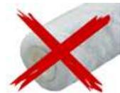
Aus Kostengründen benötigt man für die nicht PU-Flüssigkunststoffe pro Verarbeitungsschicht **"eine frische Farbrolle"**, denn das Reinigen der Werkzeuge mit dem **"Solvent"** Lösungsmittel steht in keinem Verhältnis zum Anschaffungspreis des jeweiligen Werkzeuges.
