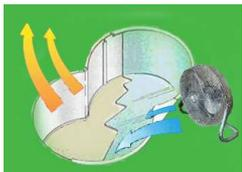
Alle verwendeten Werkstoff benötigt während ihrer Reaktionszeiten mehr oder weniger viel Sauerstoff sowie Luftfeuchtigkeit. Wir empfehlen daher ausdrücklich das Einrichten einer künstlichen Luftströmung mittels Ventilatoren, denn die Lösungsmittelgase sind schwerer als Luft und sammeln sich daher immer am Boden an. Beim Einsatz von Lösungsmittel ist auch ein entsprechender Atemschutz zu tragen.
