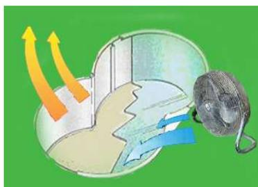
Der 2-k PU-Werkstoff benötigt während der Reaktionszeit ausreichend Sauerstoff und Luftfeuchtigkeit daher empfehlen wir das Einrichten einer künstlichen Luftströmung indem man Ventilatoren aufstellt. Insbesondere bei der Verarbeitung in geschlossenen Räumen muss für eine ausreichende Sauerstoff- bzw. Luftzirkulation gesorgt werden.
